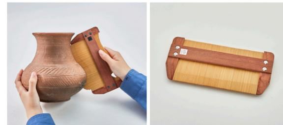
文化財部門は豊富な実績と高い技術を持ち欧米からの引き合いも多い。写真は主力商品のひとつ「真弧（マコ）」。竹刃を土器の表面に押し当て、型取った竹刃を鉛筆でなぞることで土器の形状を1：1で写し取ることができる実測道具で、「真の弧を取る」という機能からその名が付けられた。
